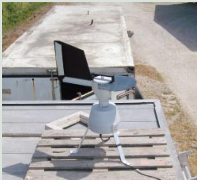
▲ Il captaspore è uno strumento che permette di catturare le spore dei funghi parassiti in un nastro settimanale da osservare poi al binocolare in laboratorio per avere un riscontro reale sulla pericolosità della malattia. (Foto DigitEco s.r.l.)
